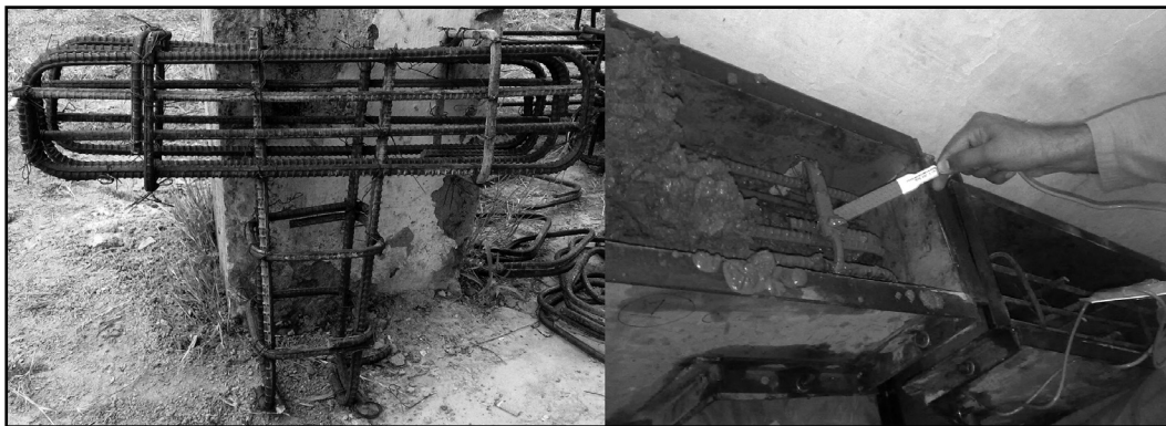
Figura 2. Detalles de la armadura (izquierda) y hormigonado de la ménsula, en la que se embebió un extensómetro a lo largo del plano de rotura previsto. Figure 2. Details of corbel reinforcement (left) and the concrete casting operation. A strain gauge was embedded along the expected plane of failure of the corbel.
